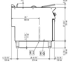
Electrical inlet (power) Equipotential screw
